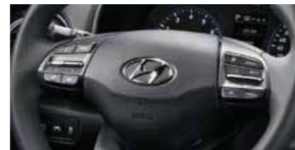
Cruise control avec limiteur de vitesse, Bluetooth et commande vocale
