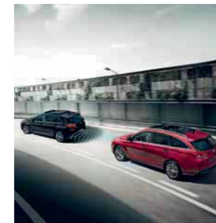
Advanced Smart Cruise Control (ASCC) maintient une distance de sécurité entre le véhicule de devant et ralentit ou accélère lorsque nécessaire.
